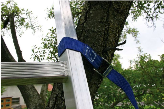
Eine durch Leitergurt korrekt gesicherte Leiter
