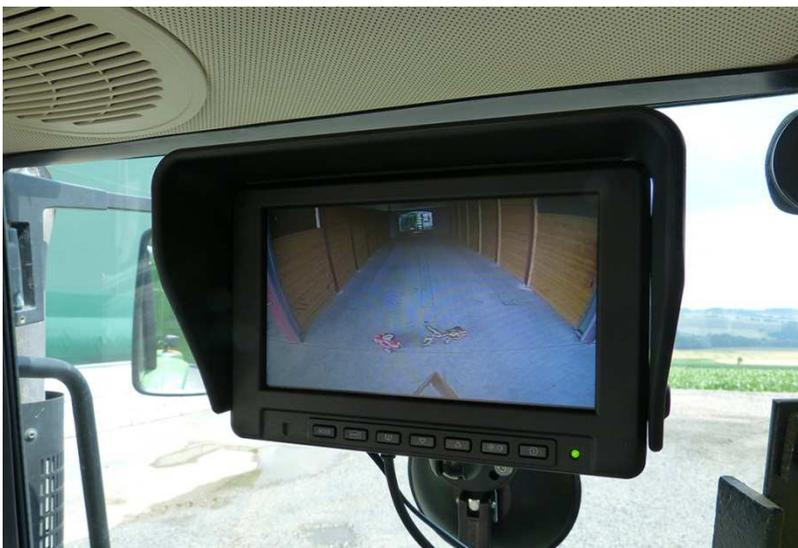
Mit einer Rückfahrkamera werden Kinder, die sich eventuell hinter dem Fahrzeug außerhalb des Sichtfeldes des Fahrers befinden, erkannt.
