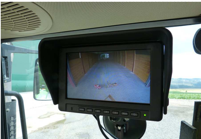
Mit einer Rückfahrkamera werden Kinder, die sich eventuell hinter dem Fahrzeug außerhalb des Sichtfeldes des Fahrers befinden, erkannt.
