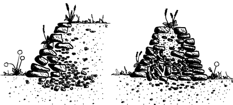
Beispiele für eine Hangmauer und eine freistehende Trockenmauer:
